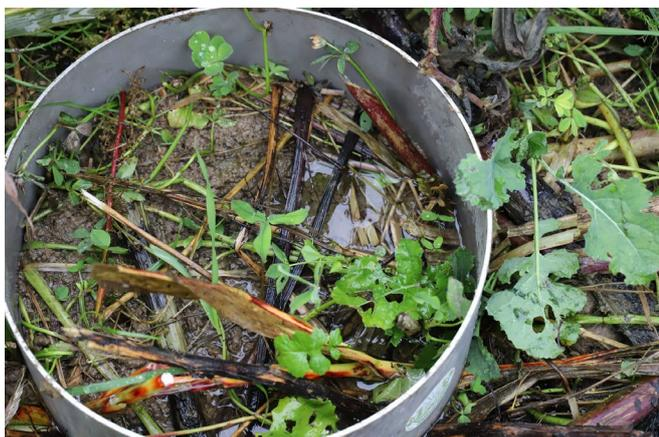
Eine der Stationen: Mithilfe des Versickerungsring wird ein Starkregenereignis simuliert und die damit verbundene Fähigkeit des Bodens zur Wasseraufnahme
